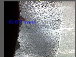
Micro escamação do revestimento
