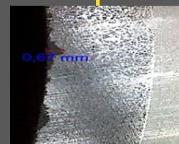
Sfaldamento sulla camicia
