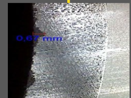
Abplatzungen an der Laufbuchse
